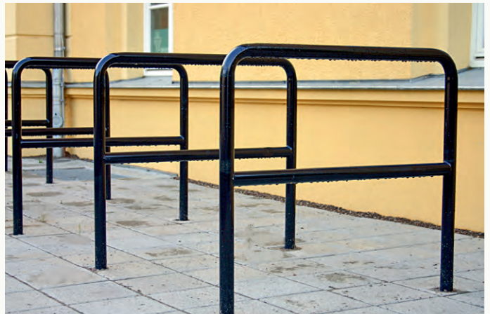
Fahrradgeländer mit Knieholm hergestellt aus Stahlrohr 48x2,5 mm zum Einbetonieren, feuerverzinkt nach DIN EN ISO 1461 wahlweise pulverbeschichtet nach RAL oder DB.
