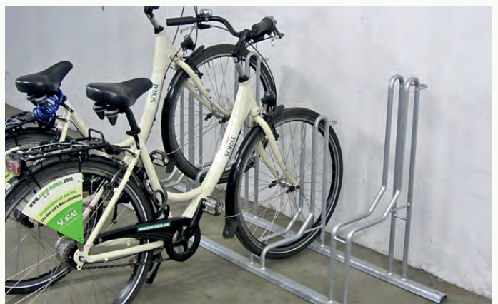
Fahrradständer Genius E/T/H hergestellt aus Stahlrohr 22 mm und Bodenträger, Reihenständer, einseitige Einstellung, passend für alle Fahrradgrößen, feuerverzinkt nach DIN EN ISO 1461 wahlweise pulverbeschichtet nach RAL oder DB.
